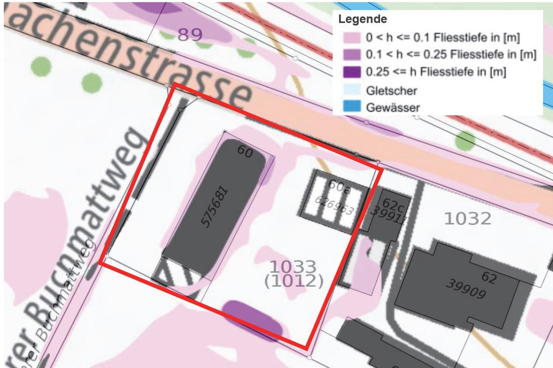
Abbildung 3: Gefährdungskarte Oberflächenabfluss [6]. Rot umrandet der Bereich des Bauvorhabens [1].
